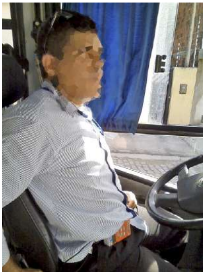
Imagem 02 - Motorista com equipamento de avaliação do ruído (dosímetro de ruído)
