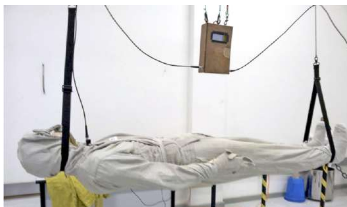
Figura 02 - Ensaio em vestimenta condutiva.
