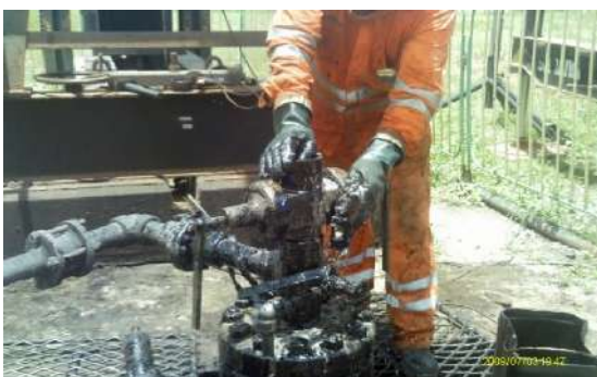
Figura 5 – Início da limpeza manual de BOP com uso de desengraxante sintético
