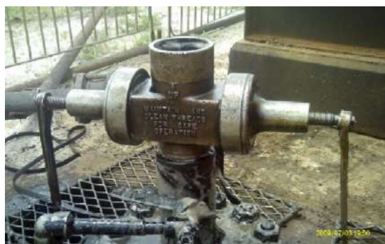
Figura 6 – BOP após a realização de limpeza com o desengraxante sintético
