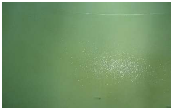
Figura 4 – Parede interna do tanque após o uso do desengraxante com desempenho superior ao querosene
